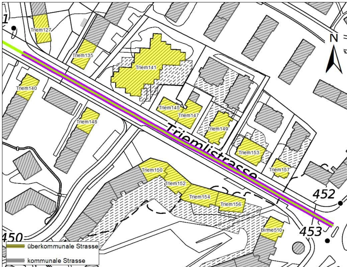
Abb. 8: Gebäude mit Überschreitungen der Belastungsgrenzwerte der LSV auf dem Strassenabschnitt Triemlistrasse (Bereich zwischen In der Ey bis Birmensdorferstrasse)
